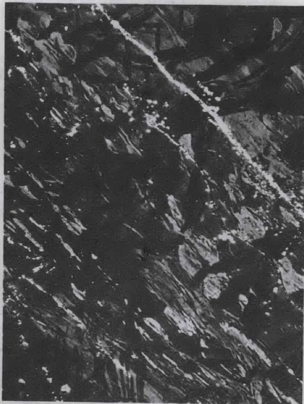
Pression : 30 kbar Température : 20°C Microdureté : 500
